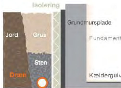
Løsningsmodel for at undgå fugtige kældervægge
